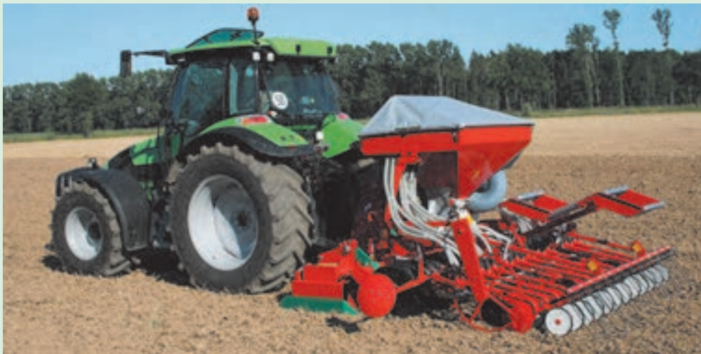
شکل ۱۱-۳. کمبینات (خطی کار مرکب)
