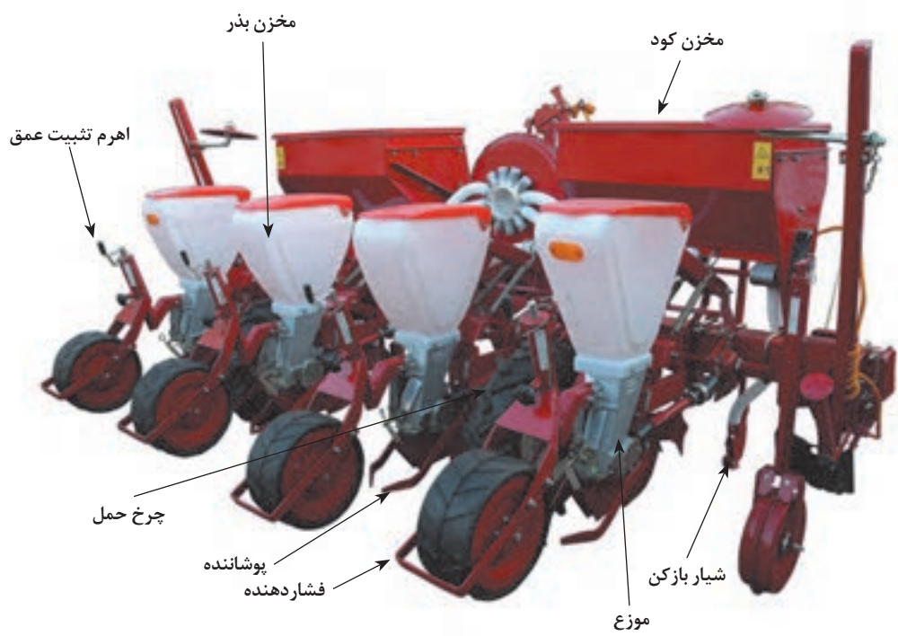
شکل ۱۶-۳. ردیف کار نیوماتیک
