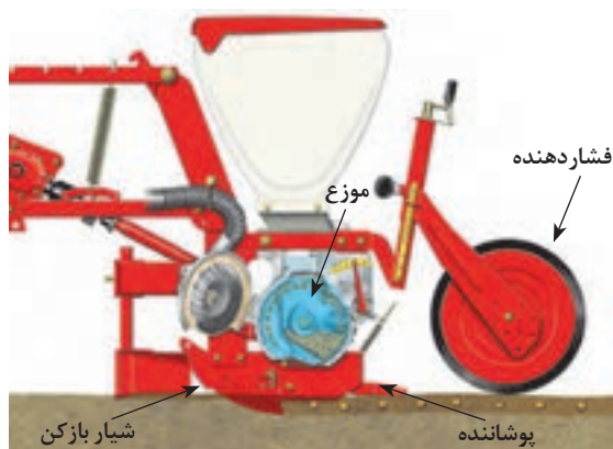
شکل ۱۴-۳. اصول کاشت بذر با کارنده
