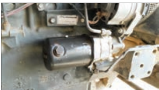
شکل ۴۰-۳- محل بازدید روغن پمپ فرمان تراکتور فرگوسن ۲۸۵
