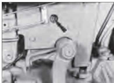
شکل ۳۹-۲- بازدید سطح روغن جعبه فرمان تراکتور ۲۸۵
