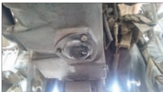
شکل ۳۲-۳- درپوش تخلیه روغن هیدرولیک تراکتور MF ۲۸۵
