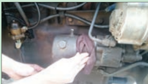
شکل ۴۱-۳- تمیز کردن پوسته روغن فرمان
