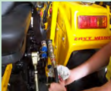
شکل ۶۵-۳- تمیز کردن سرشیلنگی و اطراف خروجی هیدرولیک تراکتور
