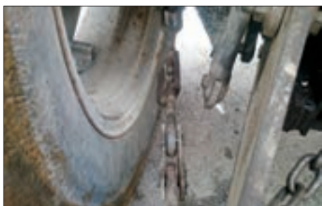
شکل ۷۸-۳- تنظیم زنجیر مهار کننده
