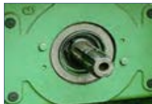
شکل ۳-۶۹- محور تواندهی ۶ خار
