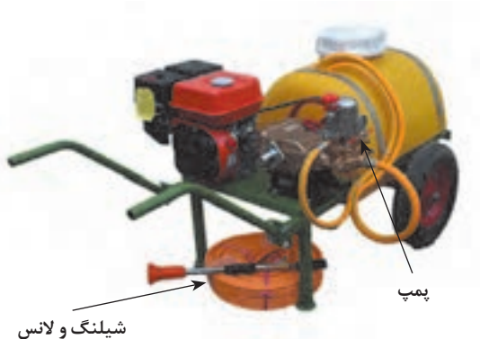
شکل ۲۹-۴. سم‌پاش فرغونی و اجزای آن
