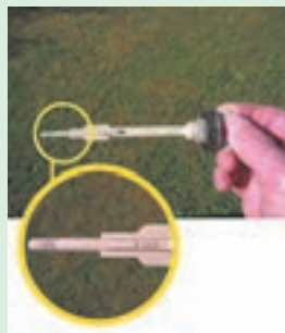
شکل ۵۷-۴. بازدید روغن موتور و شمع موتور
