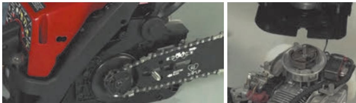
شکل ۴-۵۵. کلاچ گریز از مرکز
