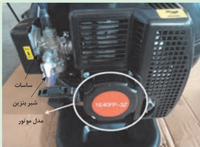
شکل ۴-۴. اجزای موتور
