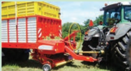
شکل ۹-۴- اتصال شیلنگ‌های هیدرولیک
