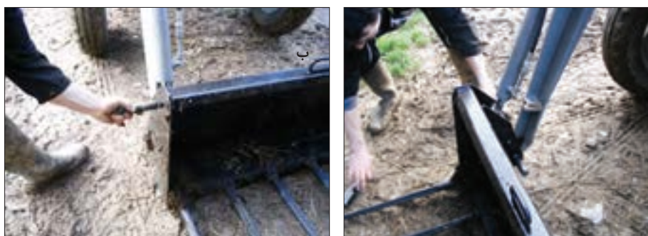
(الف) (ب) شکل ۳۱-۴-۱ اتصال باکت‌ها به بیل
