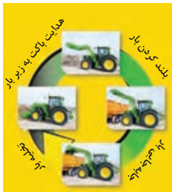
شکل ۳۷-۴ مراحل باربرداری با بیل
