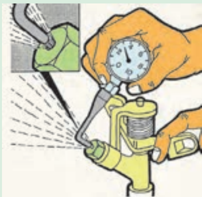
شکل ۳۵-۵. اندازه گیری با فشار سنج بوردون
