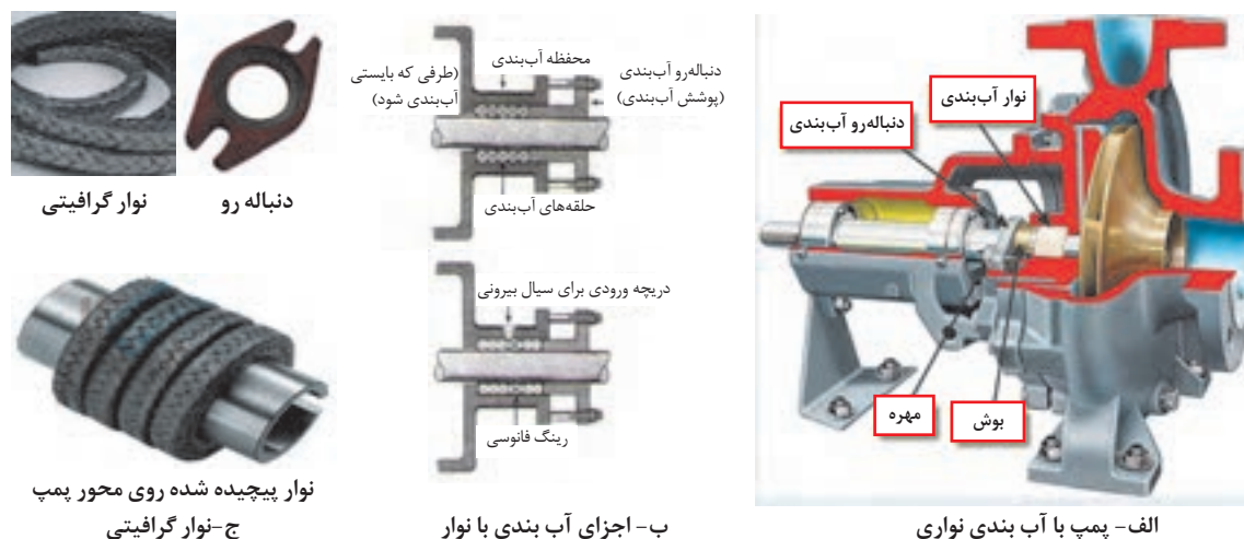
شکل ۵-۵۰. آب بندی پمپ با نوار گرافیتی
