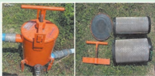
شکل ۵۷-۵. قطعات باز شده صافی توری
