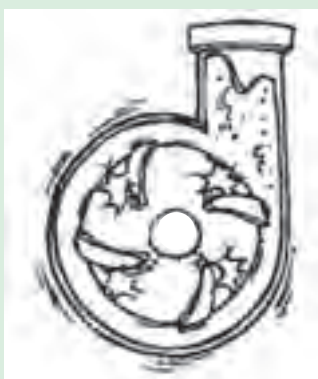
شکل ۲۹-۵. کاویتاسیون در پروانه پمپ
