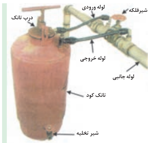
شکل ۴۹-۵. اجزای سیستم توزیع کود
