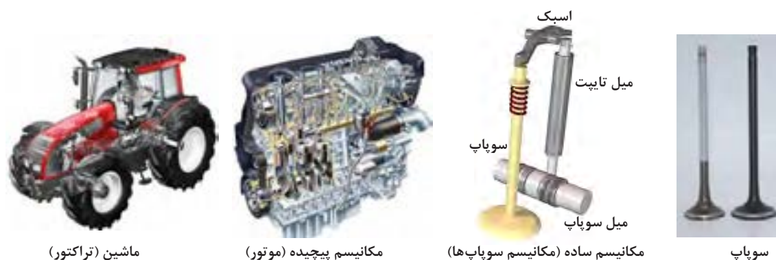
شکل ۵۰-۵-انواع مکانیسم در تراکتور
