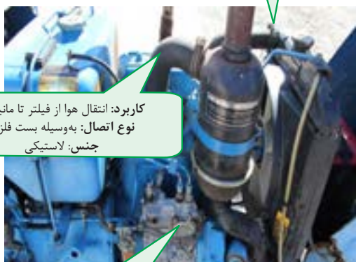
شکل ۵۵-۵- لوله‌ها و شیلنگ‌های موتور تراکتور
