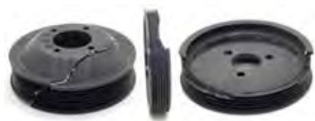
شکل ۶۷-۵- عیوب پولی
