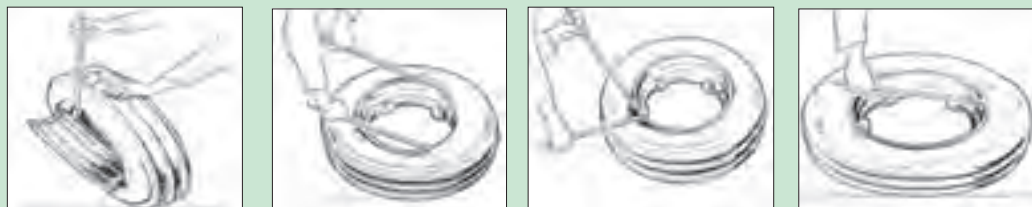
شکل ۵-۲۵ جدا کردن تایر از رینگ یک تکه
