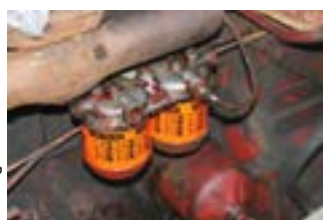
شکل ۵-۶۰- نشت گازوئیل از فیلتر
