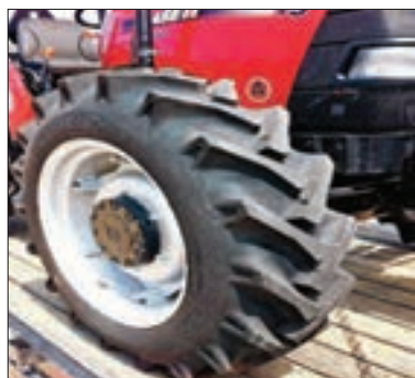
شکل ۲۱-۵- چرخ با فشار باد توصیه شده
