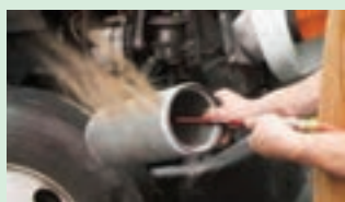
شکل ۲۸-۲- باد گرفتن صافی داخلی
