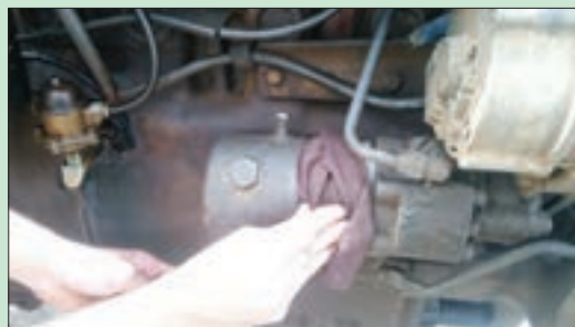
شکل ۴۱-۳ تمیز کردن پوسته روغن فرمان
