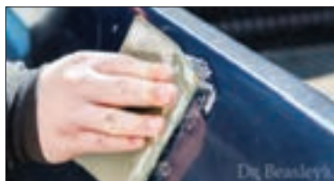
شکل ۱-۶۲- سنباده زدن ورق آهن
