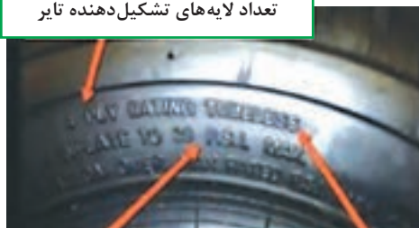
شکل ۱۷-۵- مشخصات فنی تایر
