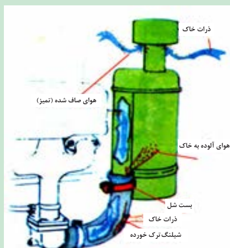
شکل ۶۱-۵- نشستی در شیلنگ‌های هوا
