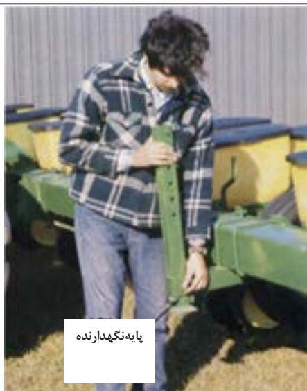
شکل ۷۹-۳ جدا کردن ماشین از تراکتور
