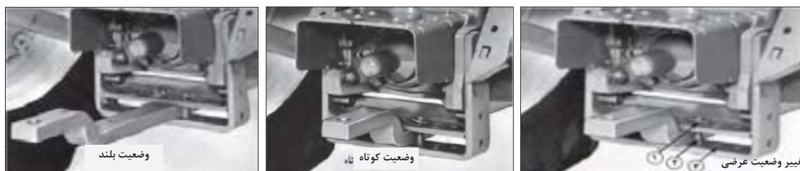
شکل ۵۷-۳-تنظیمات مالبند قابل تنظیم
