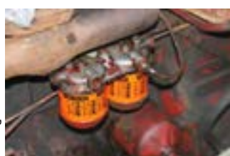
شکل ۵-۶۰- نشت گازوئیل از فیلتر
