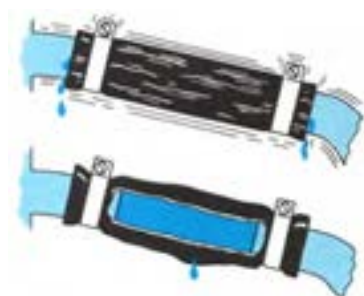
شکل ۵-۵۶- نشتی از شیلنگ ها
