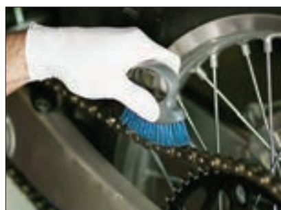
شکل ۱۴-۲ تمیز کردن زنجیر
