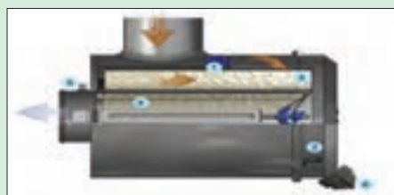
شکل ۲۳-۲- مسیر عبور هوا در صافی روغنی
