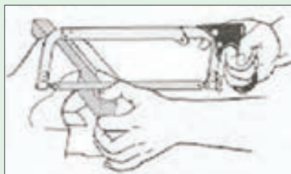
شکل ۱-۴۳- ایجاد شیار راهنما در اره کاری
