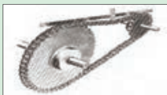
شکل ۱۲-۲ اندازه گیری کشش زنجیر
