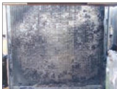
شکل ۴۰-۲ کثیف شدن سطح خارجی رادیاتور
