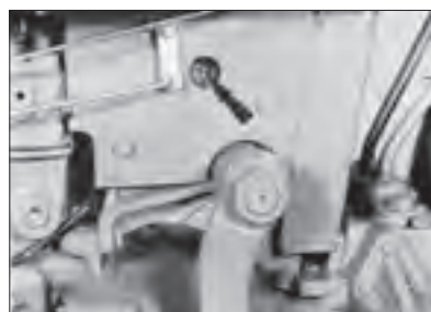
شکل ۳۹-۳- بازدید سطح روغن جعبه فرمان تراکتور ۲۸۵
