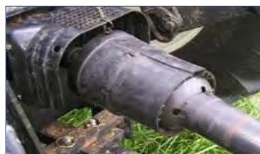
شکل ۳-۷۳- گاردان مجهز به کلاچ یک‌طرفه
