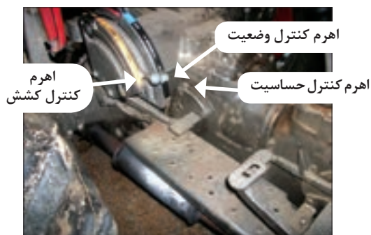
شکل ۳-۵۹- اهرم‌های کنترل هیدرولیک تراکتور فرگوسن ۲۸۵
