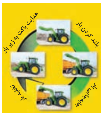
شکل ۳۷-۴ مراحل باربرداری با بیل
