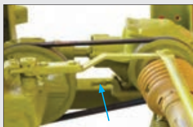
شکل ۵۰- پیچ تنظیم کشش تسمه
