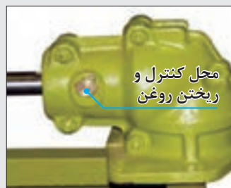
شکل ۴۶- جعبه دنده زانویی تیغه درو
