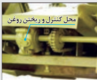
شکل ۴۷- جعبه دنده دوکفه ای
