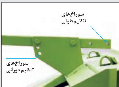
شکل ۱۳- هدایت کننده علوفه و پیچ های تنظیم آن
