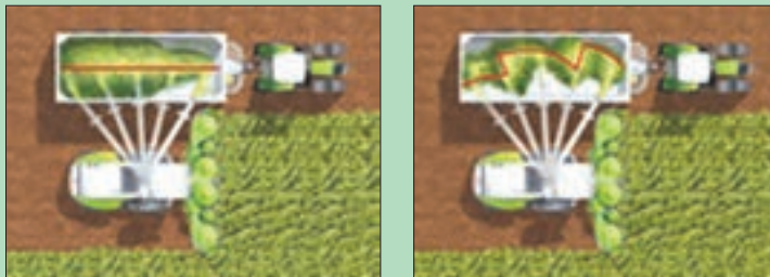
شکل ۶۰- کنترل اتوماتیک لوله تخلیه در چاپرهای جدید
