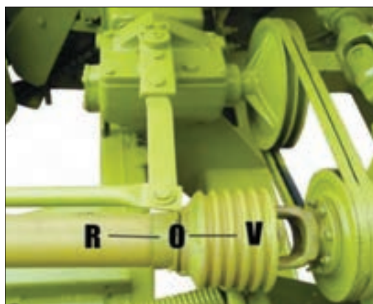
شکل ۱۸- تنظیم جهت دوران غلتک‌های تغذیه
