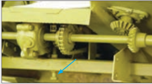
شکل ۵۱ - پیچ تنظیم زنجیر تیغه‌های درو
