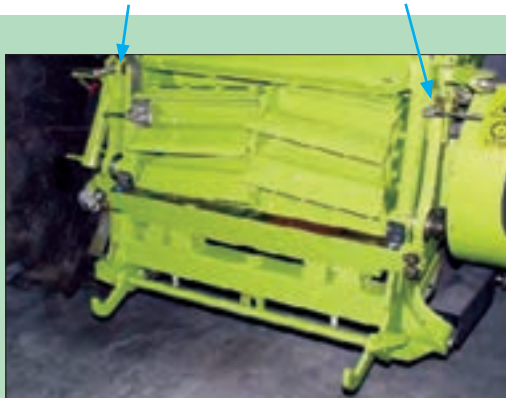
شکل ۲۸- اهرم‌های تنظیم تیغه ثابت در چاپر خودگردان
