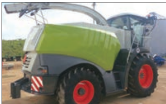
شکل ۳۶- نشیمنگاه لوله تخلیه
