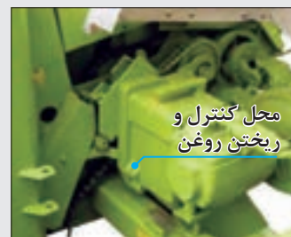
شکل ۴۵- جعبه دنده باردهی غلتک‌های تغذیه
