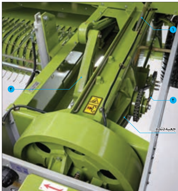
شکل ۸۲- مسیر انتقال توان در بسته‌بند
