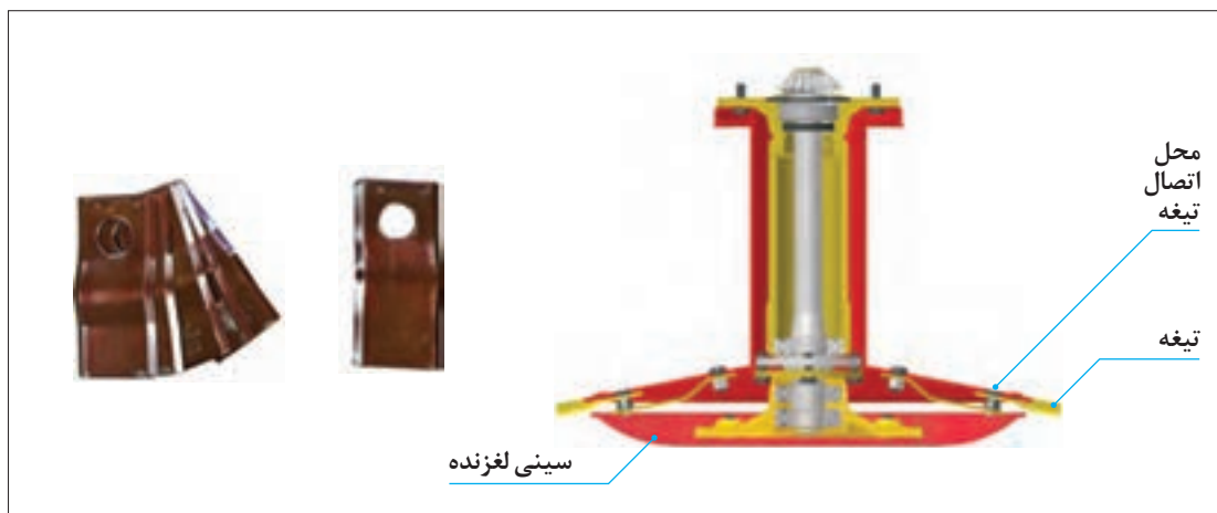
شکل ۴- تیغه و محل قرارگیری آن روی استوانه
