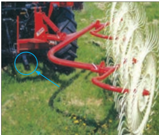
شکل ۵۹- اتصال شانه خورشیدی به تراکتور
