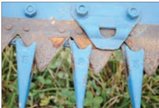
شکل ۱۰- موقعیت انگشتی و تیغه در دروگر شانه‌ای
