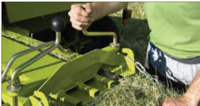
شکل ۱۰۱- تیرک‌های فشاردهنده و تنظیم آن
