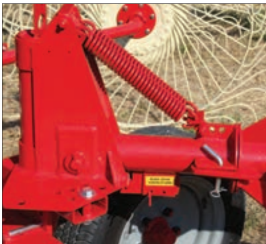
شکل ۶۰- فنرهای شناوری شانه خورشیدی
