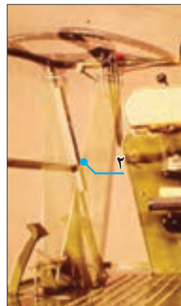
شکل ۳۶- نشانگر تنظیم ارتفاع برش
