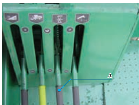
شکل ۳۹- اهرم تنظیم سرعت پروانه چرخ و فلک
