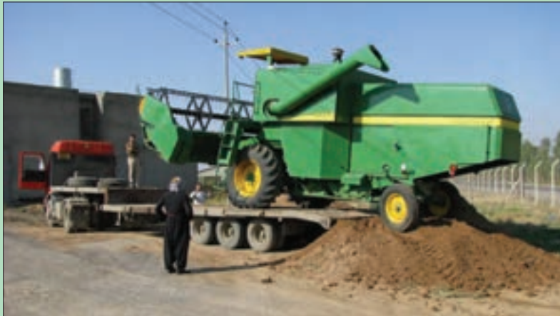
شکل ۳۵- نحوه قرار گرفتن کمباین روی یدک کش
