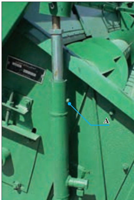
شکل ۴۲- جک هیدرولیک تنظیم ارتفاع چرخ و فلک
