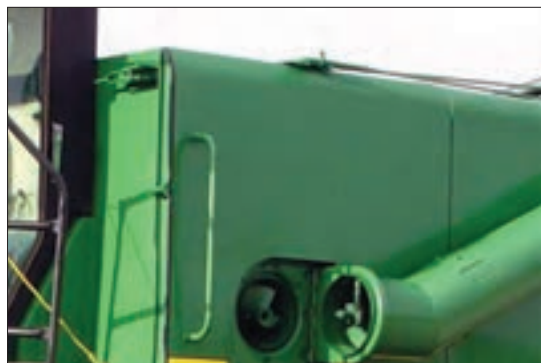
شکل ۲۸- نقاله تخلیه دانه از مخزن
