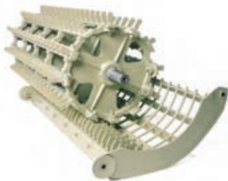
شکل ۱۸- کوبنده و ضد کوبنده چکشی
