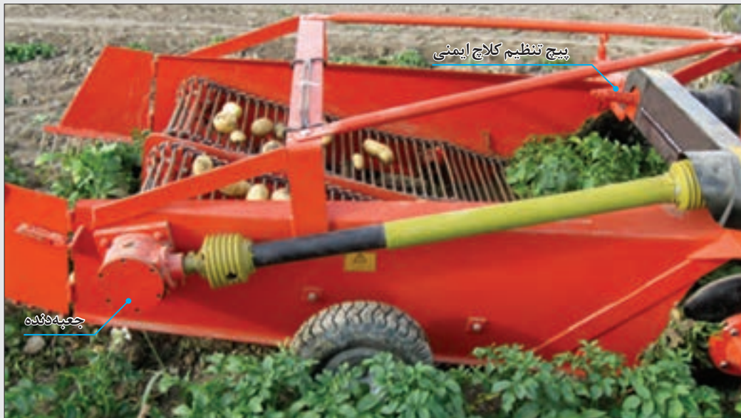
شکل ۱۹- موقعیت جعبه‌دنده و پیچ تنظیم کلاچ ایمنی در نوعی سیب‌زمینی‌کن نقاله‌ای
