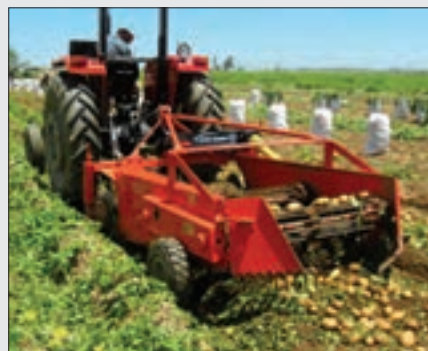
شکل ۱۷- برداشت سیب‌زمینی با سیب‌زمینی‌کن نقاله‌ای
