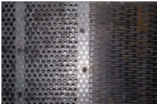
شکل ۳۱- دو نمونه غربال با سوراخ‌های متفاوت
