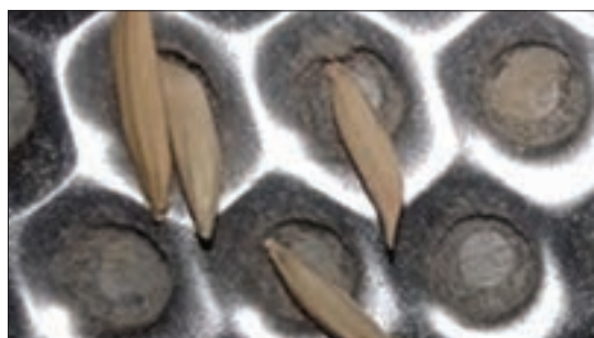
شکل ۱۶- قرار گرفتن دانه‌ها در سوراخ‌های استوانه حفره‌دار
