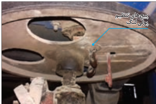
شکل ۳۴- پیچ تنظیم کورس غربال کابلی
