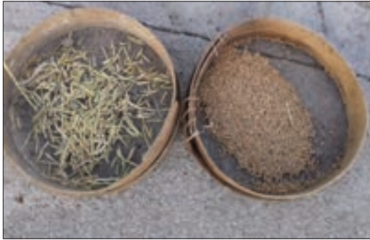
شکل ۱- جدا کردن مواد بر اساس اختلاف اندازه توسط غربال
