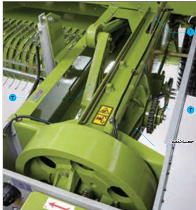
شکل ۸۲- مسیر انتقال توان در بسته‌بند
