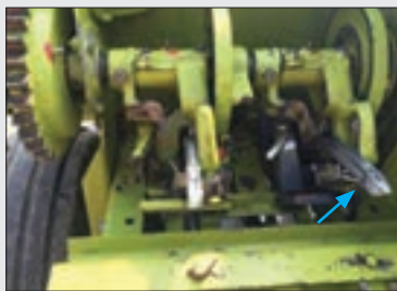
شکل ۹۳- تحویل نخ به نخ‌گیر
