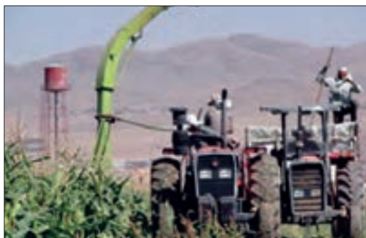
شکل ۳۲- تناسب لوله تخلیه با ماشین حمل
