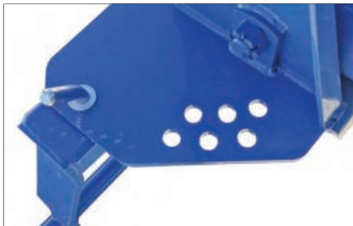
شکل ۶۲- صفحه سوراخ دار روی شاسی شانه خورشیدی و قابلیت چرخش شاسی
