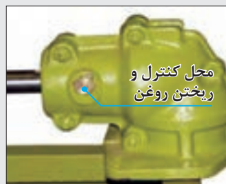
شکل ۴۶- جعبه دنده زانویی تیغه درو
