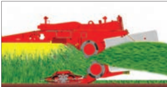
شکل ۵۶- دروساقه کوب و طرز کار آن
