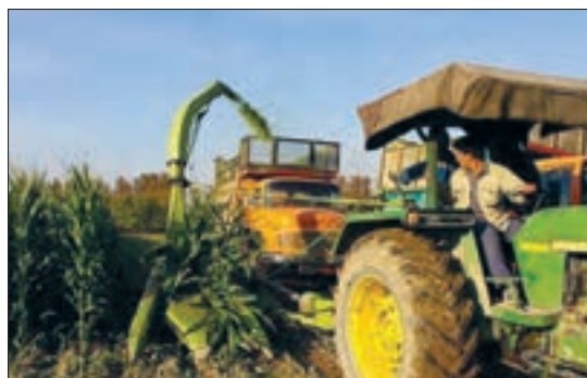
شکل ۳۲- تناسب لوله تخلیه با ماشین حمل
