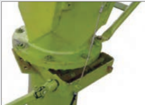
شکل ۴۰- چرخ دنده دوران لوله
