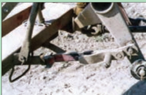
شکل ۲۰- ضامن ایمنی عمل کرده در برخورد با مانع
