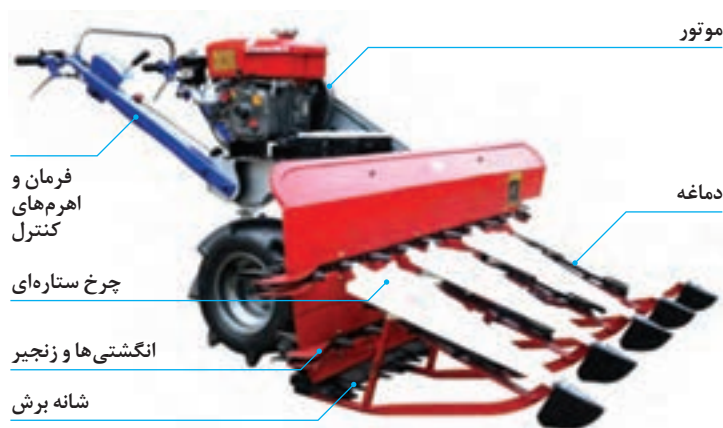
شکل ۱- درو ردیف‌کن و کاربرد آن
