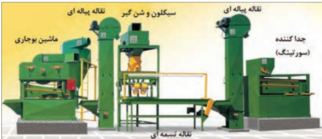
ب) خط کامل پاک کننده و درجه بندی حبوبات
