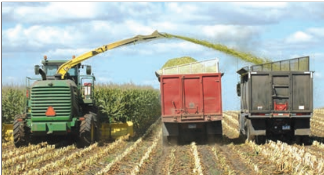
شکل ۶- برداشت ذرت به وسیله چاپر خودگردان
