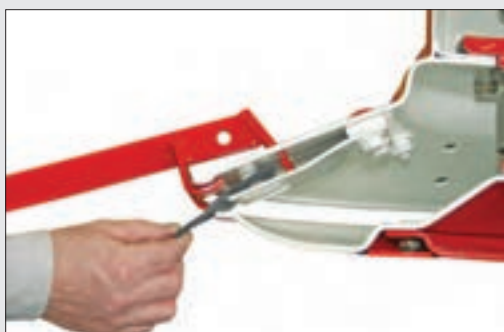
شکل ۲۲- شکل شماتیک از تعویض تیغه دروگر استوانه‌ای
