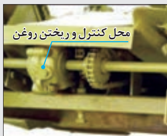
شکل ۴۷- جعبه دنده دوکفه ای
