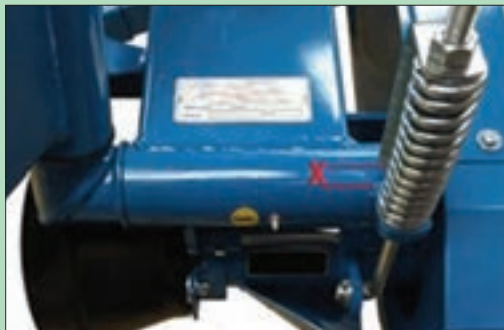
شکل ۲۱- شاخص تنظیم کشش تسمه دروگر استوانه‌ای
