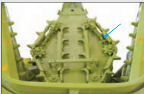
شکل ۵۲- زنجیر سفت‌کن دماغه چپر دو ردیفه
