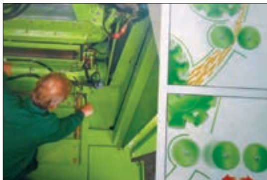
شکل ۲۱- خارج کردن بلال خردکن از مدار
