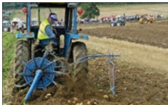
شکل ۹- سیب زمینی کن دوار در حال کار
