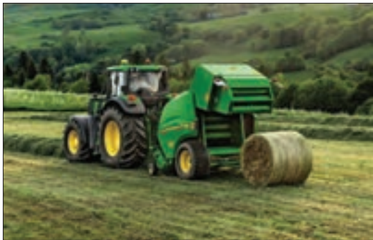
ب) بسته‌بند استوانه‌ای
