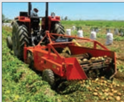
شکل ۱۷- برداشت سیب‌زمینی با سیب‌زمینی‌کن نقاله‌ای
