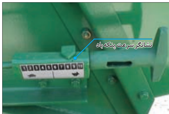
شکل ۴۴- اهرم تنظیم سرعت پنکه
