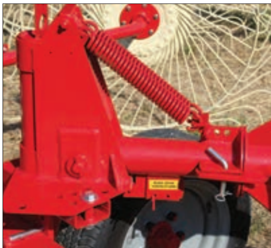
شکل ۶۰- فنرهای شناوری شانه خورشیدی
