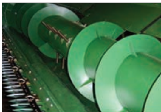
شکل ۸- نقاله پیچی واحد برش
