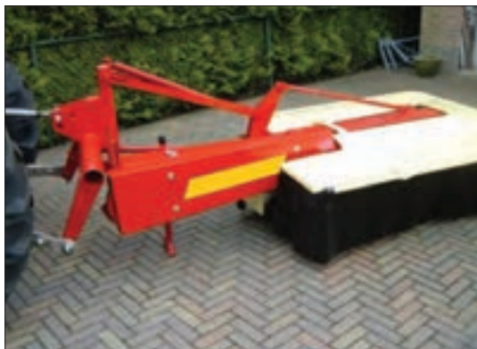
شکل ۲۹- دروگر در وضعیت حمل و نقل
