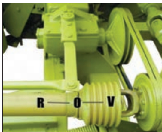
شکل ۱۸- تنظیم جهت دوران غلتک‌های تغذیه
