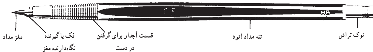
شکل ۷- مداد اتود و قسمت های مختلف آن
