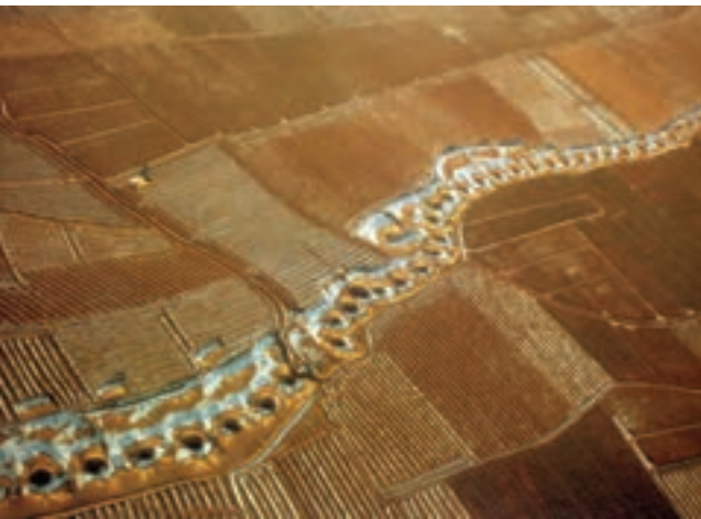
تصویر شماره ۲-۴۸- نمایی از مسیرهای قنات
