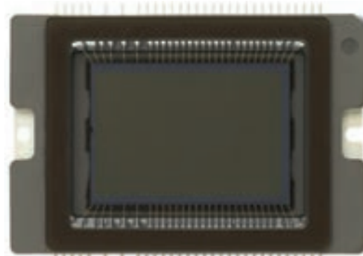
تصویر ۱-۳- دی‌اگرام یک حسگر دوربین دیجیتال
