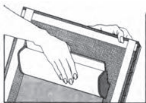
تصویر ۱۲۲- طرز کشیدن ماده حساس روی توری
