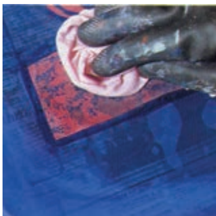
تصویر ۱۳۴- زدودن رنگ‌ها به کمک پارچه و حلال رنگ
