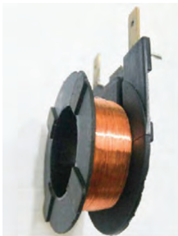
شکل ۲- سیم پیچ داخل موتور
