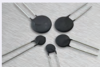
(ب) تصویری از چند ترمیس‌تور دیسکی واقعی
