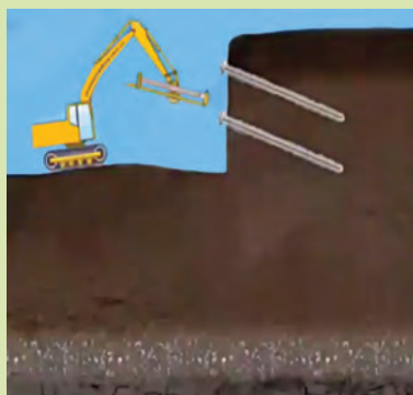
پایدارسازی شیب به روش میخ‌کوبی
