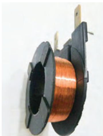
شکل ۲- سیم پیچ داخل موتور
