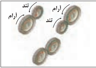
چرخ‌دنده‌های قطاری گروهی از چرخ‌دنده‌ها هستند که با هم درگیر هستند. موازی، بالا برنده و پایین آورنده دنده
