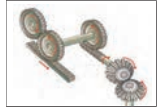
چرخ‌دنده‌های گوناگون در یک ماشین کاربردهای متنوعی دارند اما درگیر با هم هستند، جهت حرکت یا اندازه سرعت را تغییر می‌دهند
