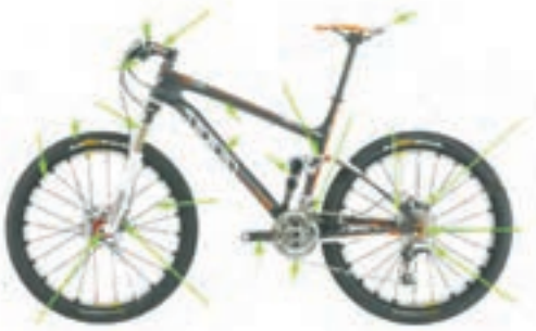
شکل ۳ - دوچرخه از اجزا یا ماشین‌های ساده‌تری مانند: اهرم، پیچ و مهره، چرخ و محور، چرخ‌دنده و... تشکیل شده است.
