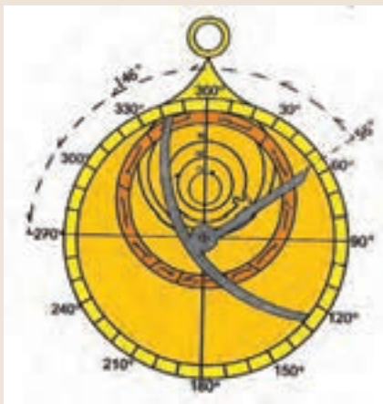
اسطرلاب زورقی: به جای آن که صفحه ستارگان روی آن بچرخد، منحنی‌های افق و ارتفاع می‌گردند. (این تصویر برگرفته از پایان نامه کارشناسی ارشد آقای جواد حسینی طباطبایی به نام «پژوهشی درباره اسطرلاب زورقی» است که در پژوهشکده تاریخ علم دانشگاه تهران دفاع شده است.)
