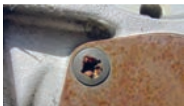
ب) استفاده ناصحیح از آچار پیچ گوشتی
