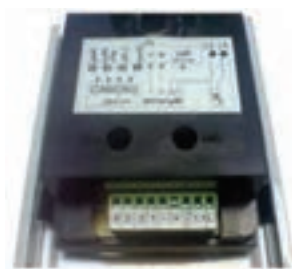
شکل ۲۵- محل تنظیم صدای بلندگو و میکروفون
