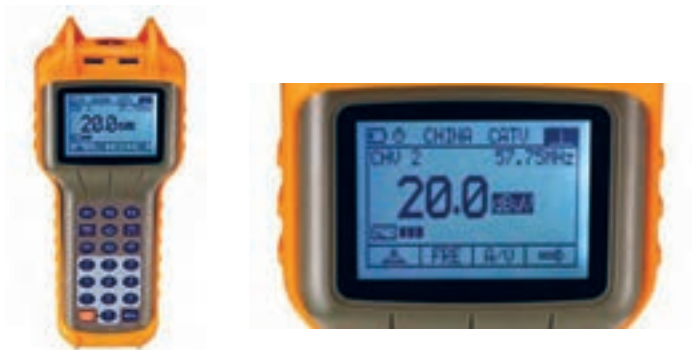
شکل ۲۴- اندازه‌گیری سیگنال خروجی آنتن توسط سیگنال سنج
