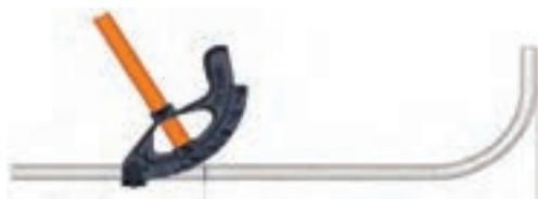
شکل ۲۷- اجرای خم دوم
