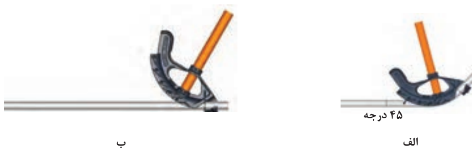
شکل ۳۳- خم انحرافی با لوله خم‌کن دستی
