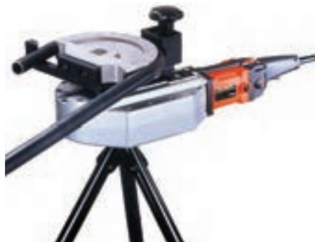
شکل ۱۷- خم کردن لوله
