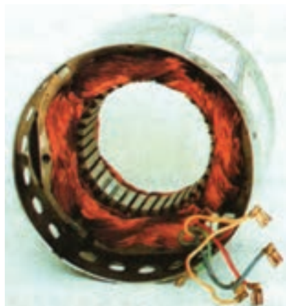
شکل ۷۰- سرسیم‌ها و سیم‌پیچی‌های موتور الکتریکی کولر آبی
