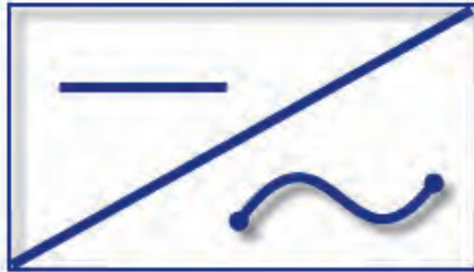
شکل ۴- تبدیل ولتاژ مستقیم به متناوب
