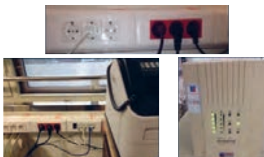
شکل ۱۶ - اتصال چند بار مختلف به UPS
