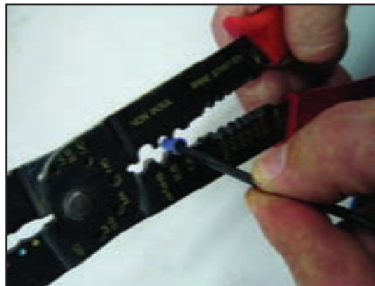
شکل ۱۹- پرس سرسیم
