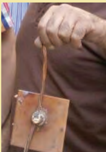
شکل ۹۷- جوش اگزوترمیک
