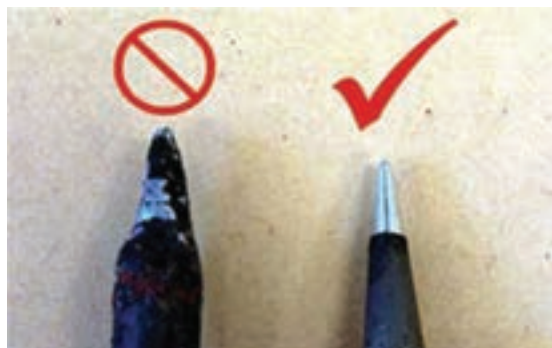
شکل ۴۵- لحیم کاری
