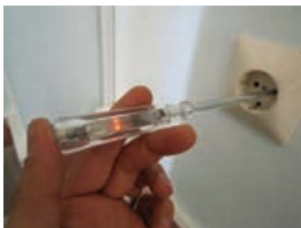
شکل ۴ - کاربرد صحیح فازمتر
