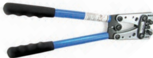
شکل ۵۸ – دستگاه پرس کابلشو
