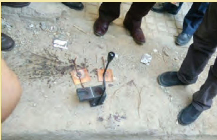
شکل ۹۸- رعایت فاصله از بوته مخصوص جوش اگزوترمیک
