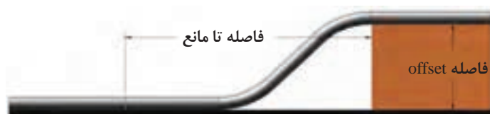
شکل ۳۵- هم‌راستا کردن امتداد لوله
