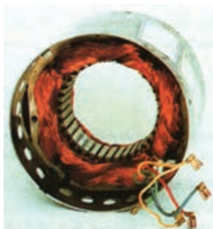
شکل ۷۰- سرسیم‌ها و سیم‌پیچی‌های موتور الکتریکی کولر آبی
