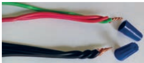
شکل ۴۳- بستن کانکتور پیچی
