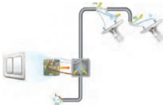
شکل ۲۷ - مدار کلید دوراهاه (دابل)
