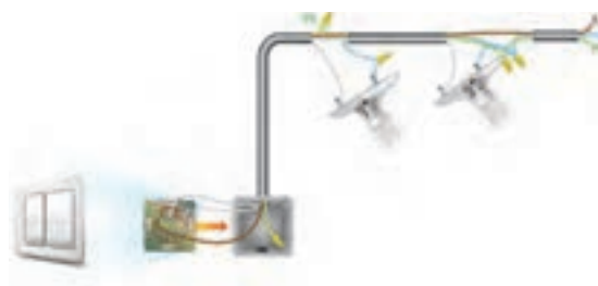
شکل ۲۷ - مدار کلید دوراهاه (دابل)
