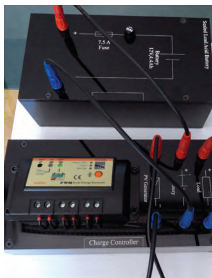
شکل ۳۷- اتصال کنترل کننده شارژ به مدول
