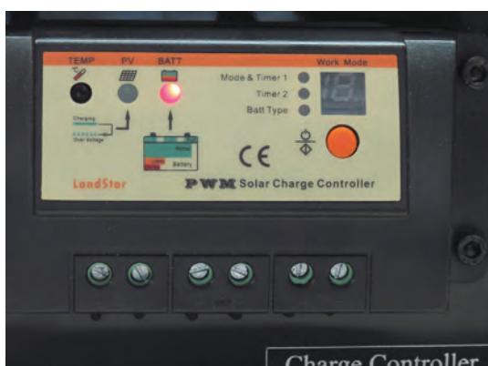
شکل ۳۶- با اتصال باتری LED روشن می شود.
