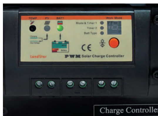
شکل ۳۶- با اتصال باتری LED روشن می شود.
