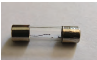
شکل ۴۹- فیوز سر راه باتری سوخته است.
