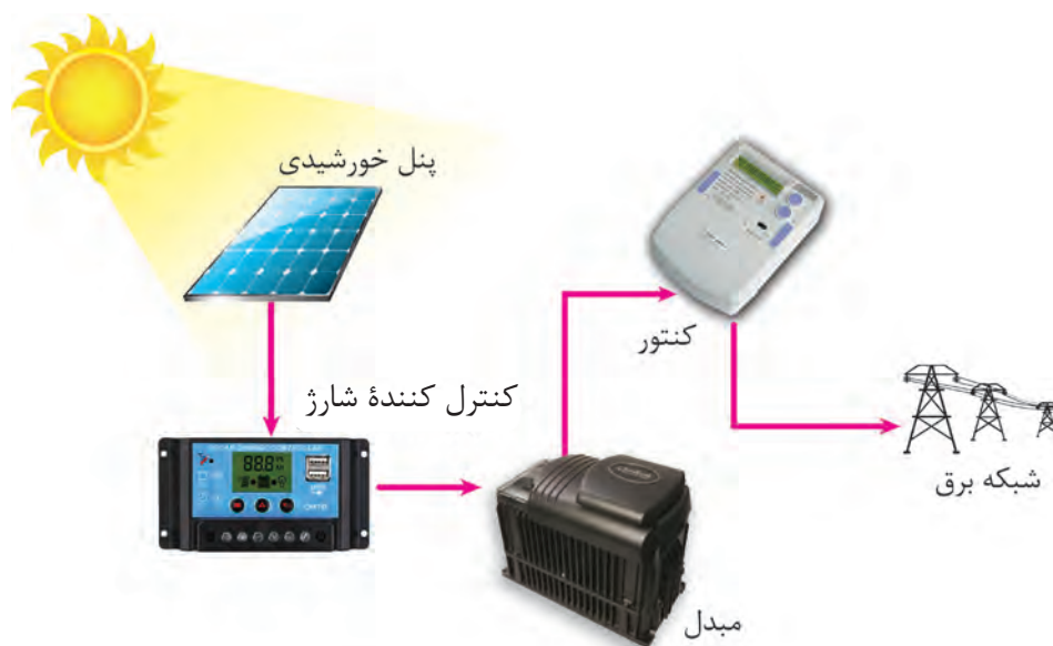
شکل ۵۱- نقشه ارتباط عناصر سیستم فتوولتائیک On_Grid
