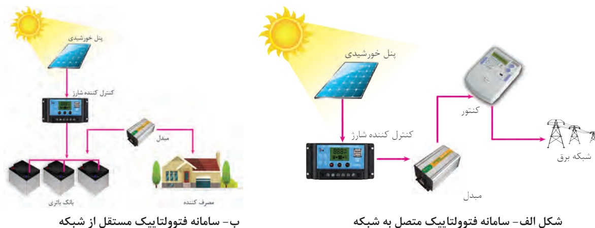
شکل ۵- سامانه متصل به شبکه و مستقل از شبکه
