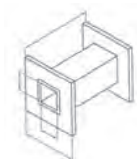
شکل ۲۰- ابعاد قرقره ترانسفورماتور
