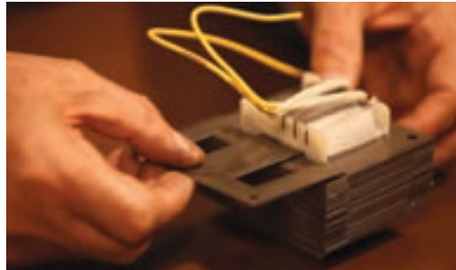
شکل ۳۷- جا زدن هسته
