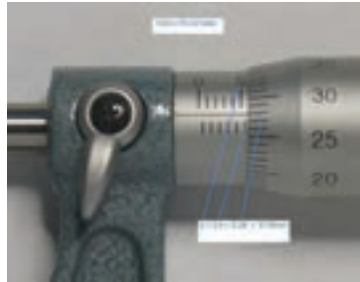
شکل ۱۴- اندازه‌گیری قطر اجسام با میکرومتر
