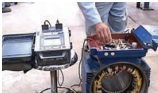
آزمایش تست بدنه موتور با دستگاه میگر
