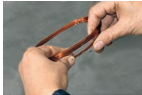
شکل ۳۸-۱ طریقه در دست گرفتن کلاف
