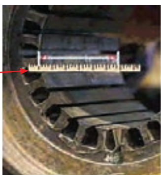
شکل ۲۷- اندازه گیری طول و قطر داخلی استاتور
