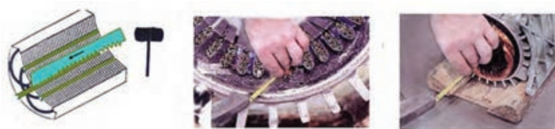
شکل ۲۳- خارج کردن پرسپان از شیار
