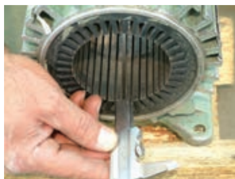
شکل ۲۷- اندازه گیری طول و قطر داخلی استاتور
