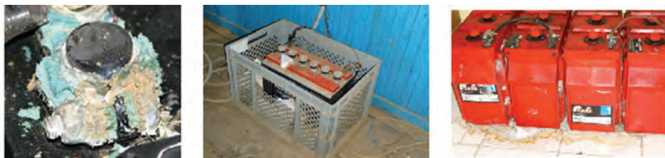
شکل ۲۱- سولفاته و نشستی باتری
