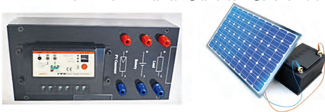
شکل ۱۳- اتصال مستقیم باتری به مدول
