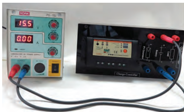
شکل ۱۹- حالت کنترل دشارژ
