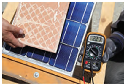
شکل ۷- ب - اثر سایه بر جریان اتصال کوتاه
