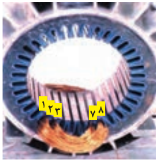
شکل ۲۶- جای‌گذاری گروه کلاف شماره ۱ در شیارهای ۲ به ۸ و ۳ به ۷
