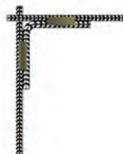
نحوه جوشکاری میلگردها در یک گوشه
