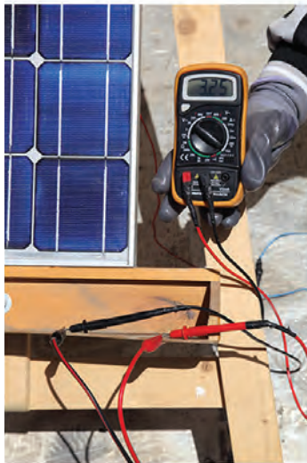
شکل ۱۵-۲ اندازه‌گیری جریان اتصال کوتاه
