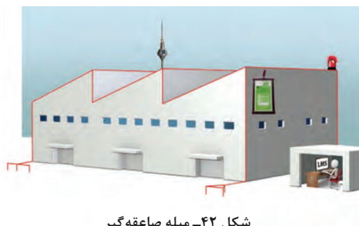
شکل ۴۲- میله صاعقه گیر
