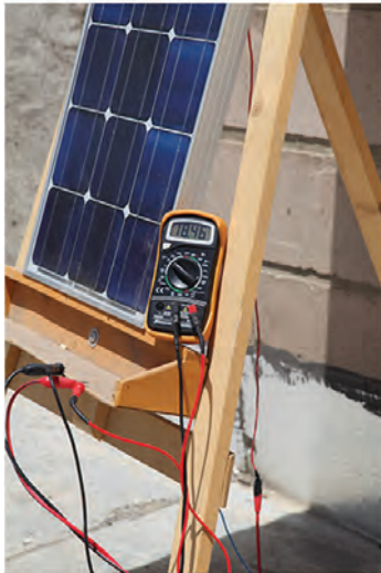
شکل ۱۵-۱ اندازه‌گیری ولتاژ بی‌باری
