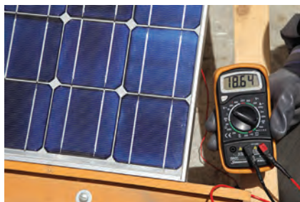
شکل ۷- الف - اثر سایه بر ولتاژ بی‌باری
