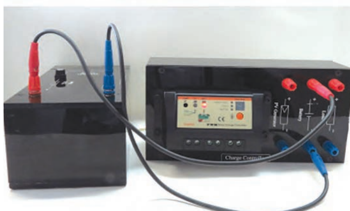
شکل ۱۱- باتری کاملاً شارژ نیست
