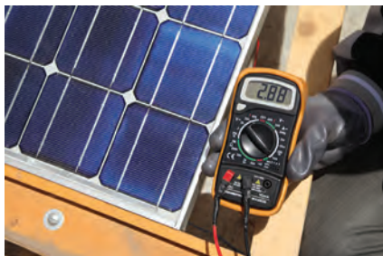
شکل ۷- ب - اثر سایه بر جریان اتصال کوتاه
