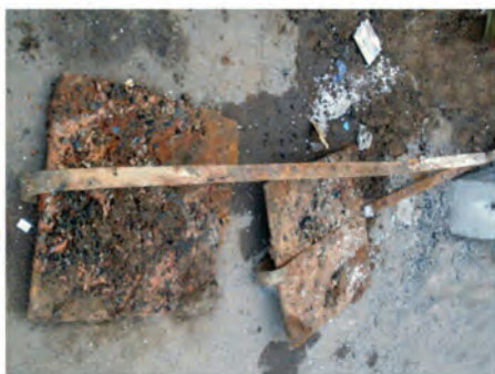
شکل ۲۵- خوردگی در اتصالات
