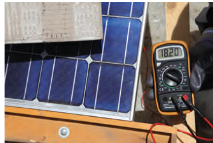
شکل ۷- الف - اثر سایه بر ولتاژ بی‌باری
