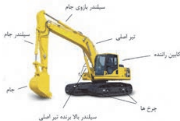
شکل ۵- قسمت‌های مختلف بیل مکانیکی
