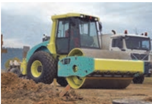
شکل ۱۱- غلتک چرخ فولادی
