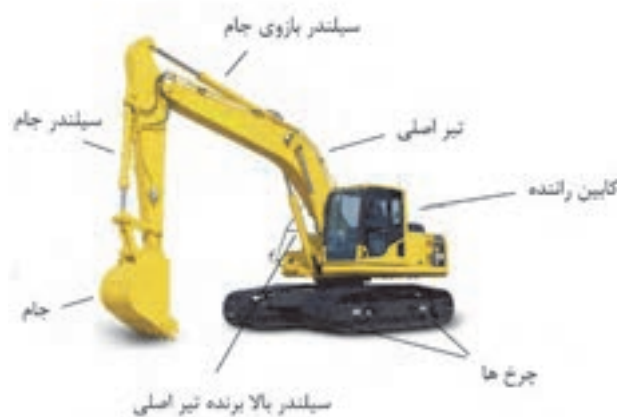
شکل ۵- قسمت‌های مختلف بیل مکانیکی
