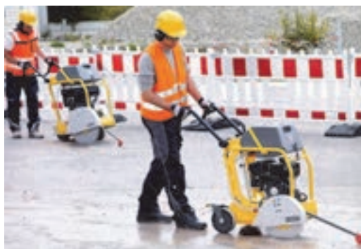
شکل ۱۷- دستگاه برش آسفالت دستی
