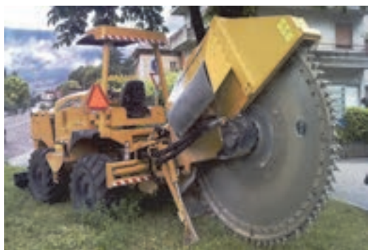
شکل ۱۸- دستگاه برش آسفالت ماشینی
