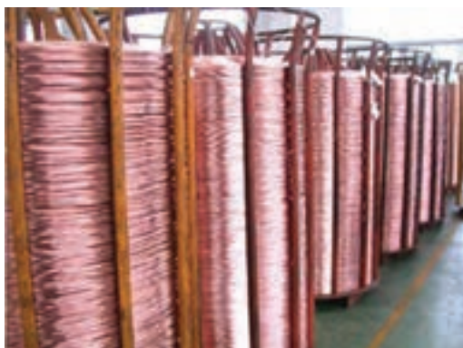
شکل ۱۱-۵- نحوه انبار کردن رول‌ها
