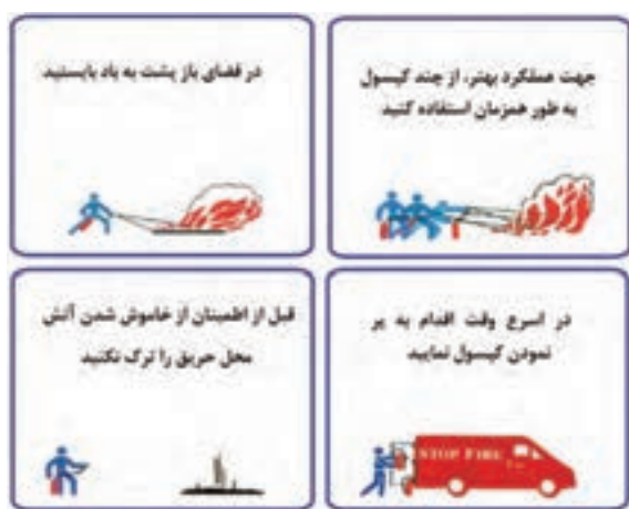
شکل ۱۷-۳ نکات مهم در به کارگیری خاموش کننده‌های دستی
