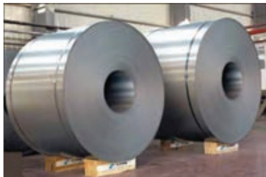
شکل ۱۱-۵- نحوه انبار کردن رول‌ها
