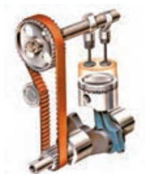
تسمه سفت کن شکل ۳-۵۶
