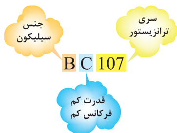
شکل ۳۱-۱۴- مشخصات ترانزیستور BC107
