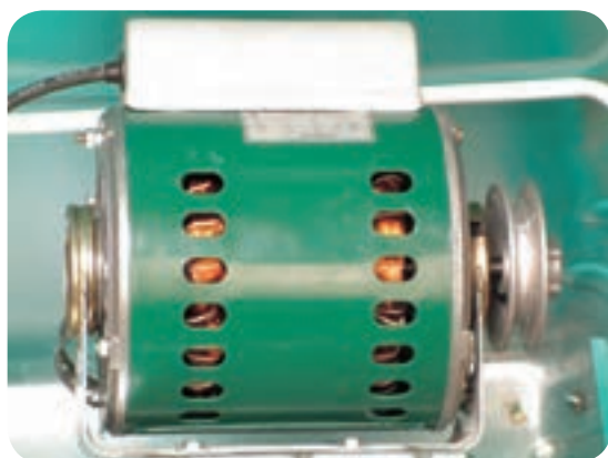
شکل ۵-۱۰ موتور الکتریکی تک فاز
