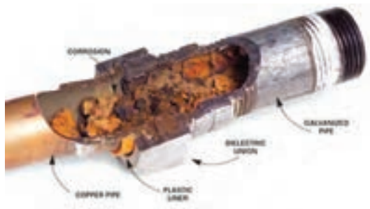
خوردگی لوله فولادی گالوانیزه در اتصال با لوله مسی
