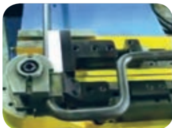
خم کاری لوله
