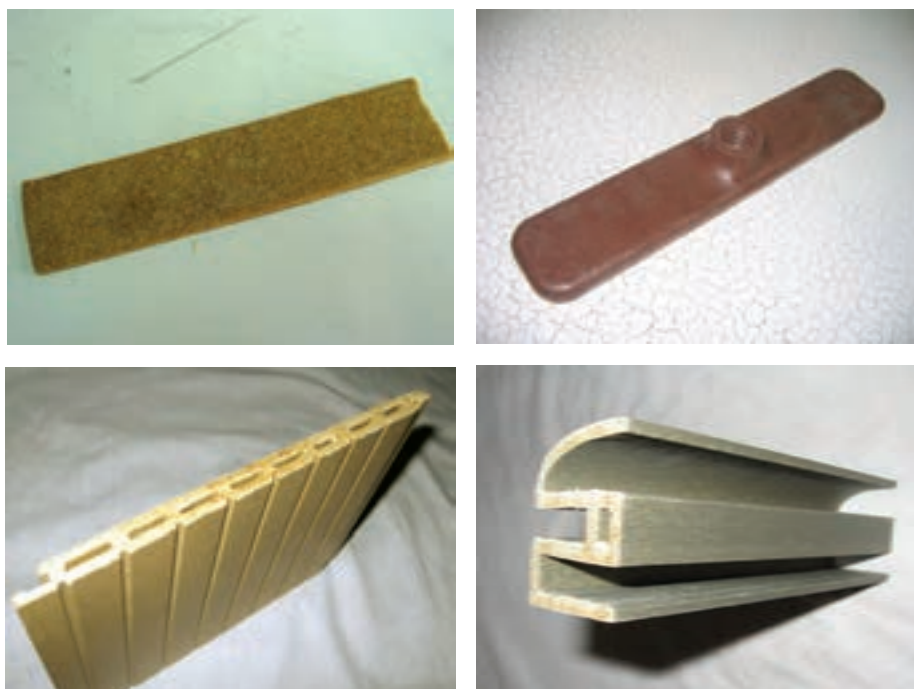
شکل ۲-۷۸- نمونه‌هایی از فرآورده‌های چوب - پلاستیک (WPC)
