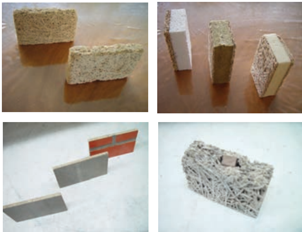
شکل ۲-۷۷- نمونه‌هایی از پانل‌های چوبی با اتصال معدنی
