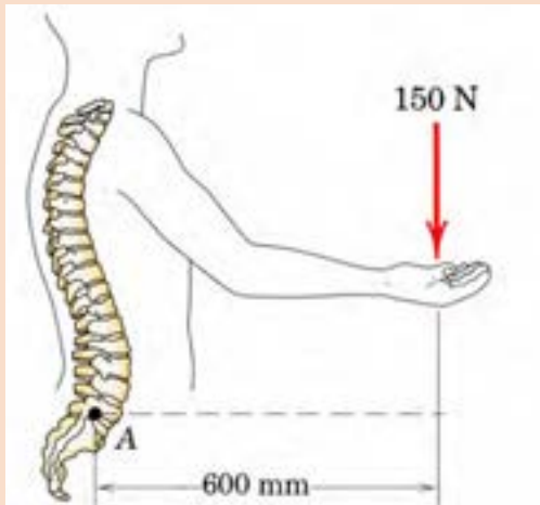
شکل ۵-۱۷ - گشتاور وارده به ستون فقرات بر اثر بلند کردن بار توسط دست‌ها
