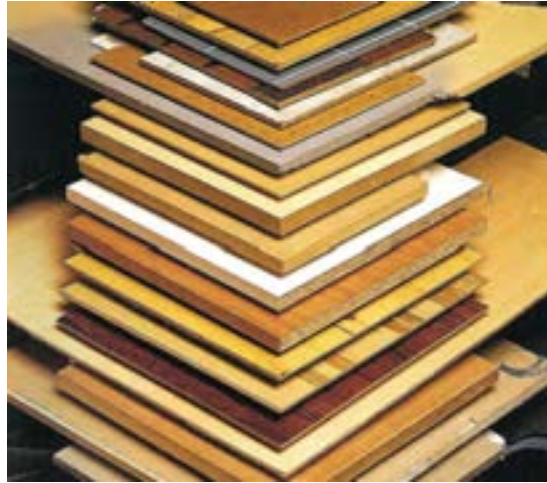
شکل ۲-۵۰- تخته خرده چوب با روکش مصنوعی
