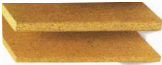
شکل ۲-۴۹- تخته خرده چوب خام
