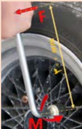
شکل ۵-۱۸ - باز کردن پیچ چرخ خودرو توسط آچار چرخ
