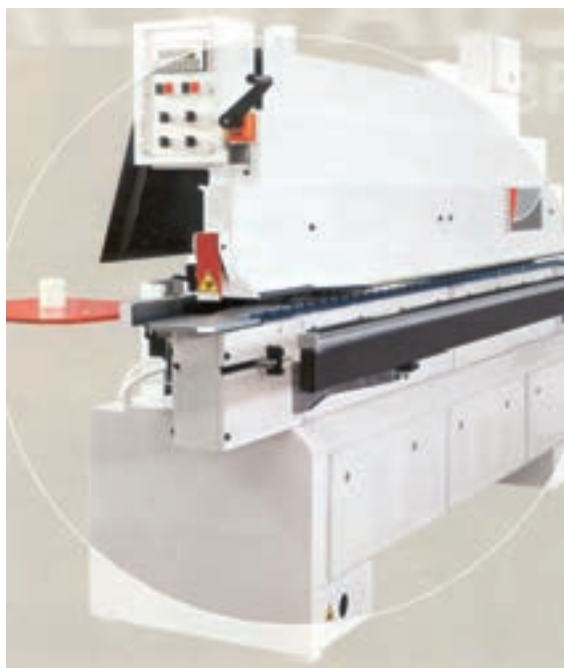
شکل ۲-۷۰- دستگاه لبه چسبان (پی‌وی‌سی) (این دستگاه در انواع ایرانی و خارجی ساخته می‌شود) و نمونه‌هایی از نوارهای پی‌وی‌سی و کاغذی
