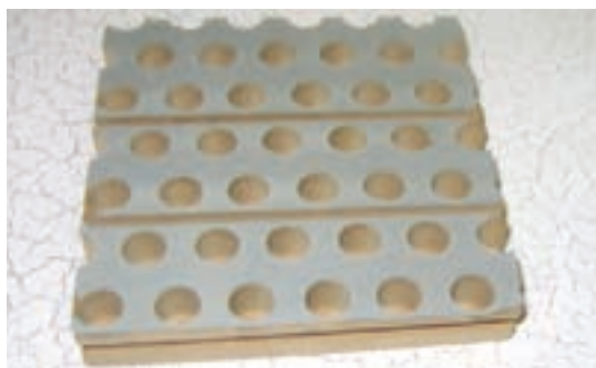
شکل ۲-۷۳ - تخته فیبر عایق (اکوستیک)
