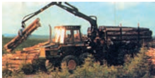
شکل ۲۲-۲ کامیون‌هایی که مجهز به جراثقال هستند گرده‌بینه‌ها را جابه‌جا می‌کنند.
