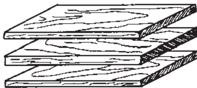
شکل ۲-۵۷ - تخته چند لایه مطبق
