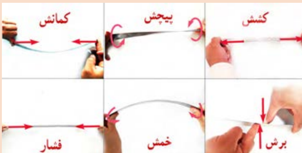
شکل ۱۲-۵ - انواع بارگذاری بر روی خط کش فلزی
