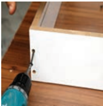
شکل ۵۳ - سوراخ کاری
