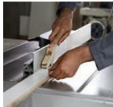
شکل ۵۱ - شیارزدن
