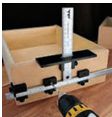
شکل ۱۳۴- چند نوع شابلون سوراخ کاری محل دستگیره
