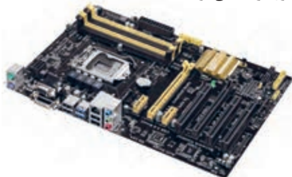
شکل ۸ - برد اصلی با فرم فاکتور ATX
