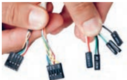
شکل ۴۴- کانکتورهای پنل جلوی کیس
