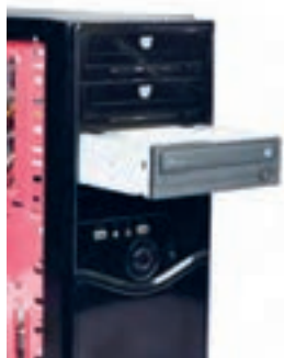
شکل ۵۰- قراردادن دیسک گردان نوری در کیس
