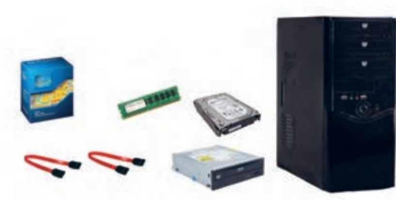
شکل ۳۰- قطعات مورد نیاز مونتاژ
