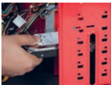
شکل ۴۸- محل نصب دیسک سخت
