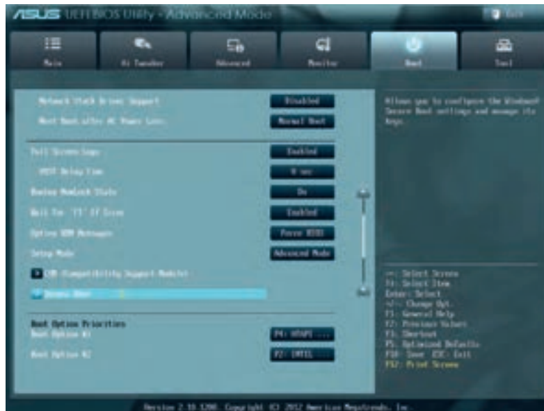
شکل ۵۷- زبانه Boot در UEFI BIOS
