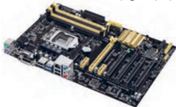
شکل ۸ - برد اصلی با فرم فاکتور ATX
