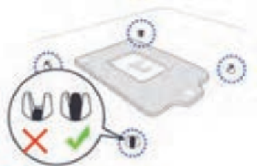
شکل ۳۸- پایه‌های سیستم خنک‌کننده در پشت برد اصلی
