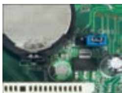
شکل ۱۴- جامپر Clear CMOS
