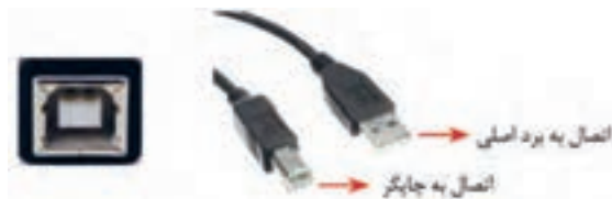
شکل ۱۹- درگاه اتصال USB به چاپگر و کانکتورهای دوسر کابل چاپگر برای اتصال
