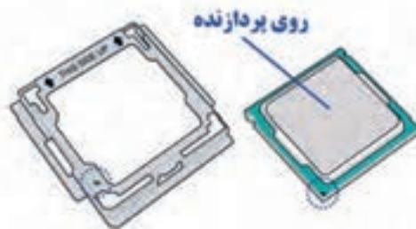
شکل ۳۴- نشانه روی پردازنده و سوکت
