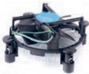
شکل ۳۶ - سیستم خنک‌کنندهٔ پردازنده
