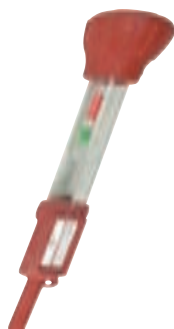
شکل ۶- هیدرومتر
