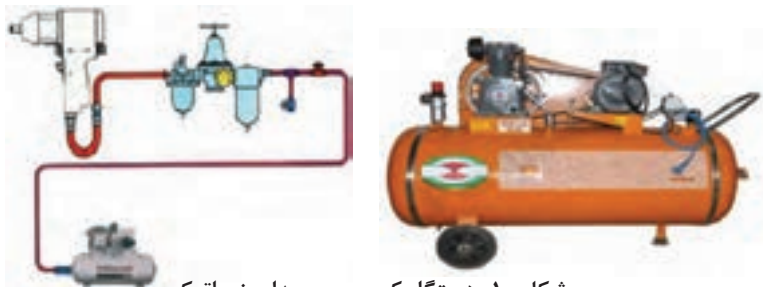
شکل ۱۰- دستگاه کمپرسور و مدار پنوماتیک
