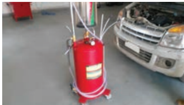
تعویض روغن موتور با ساکشن
