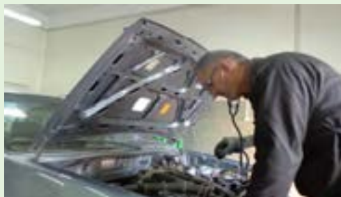
شکل ۲۰-۲- استفاده از گوشی مکانیکی
