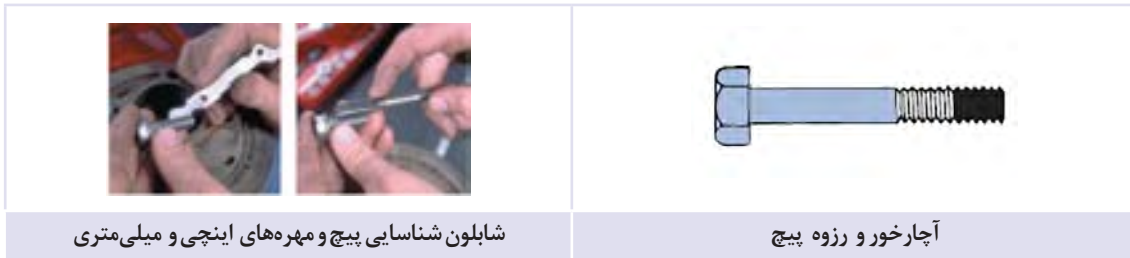
شکل ۱۳-۱ - شناسایی رزوه پیچ
