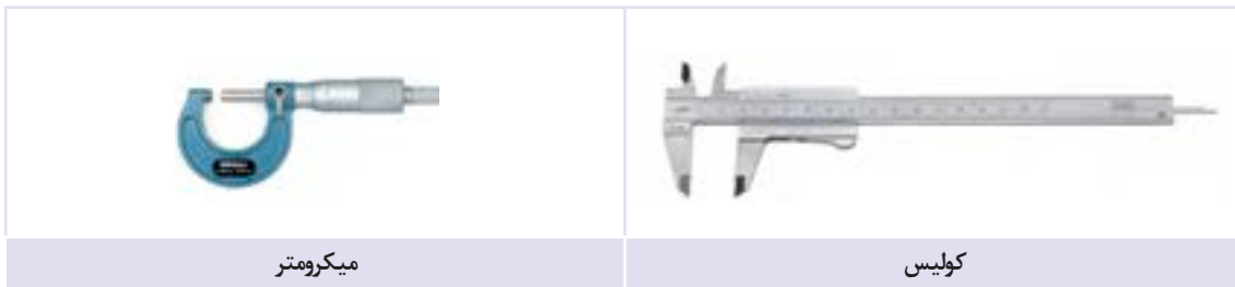
شکل ۱۴-۱ وسایل اندازه‌گیری دقیق
