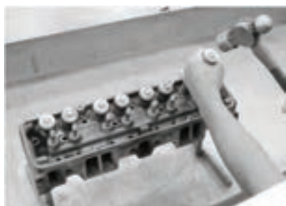
استفاده از بوش و ضربه به بشقابک فنر سوپاپ
