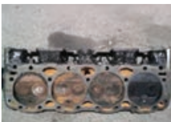
ورود مایع خنک کننده به سرسیلندر
