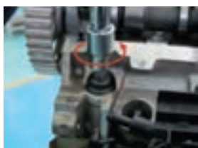
جهت باز کردن پیچ های سرسیلندر
